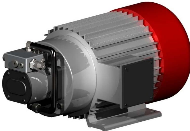
**DYNAGEN** Generatoren können von einer bereits vorhanden Load Sensing Hydraulikpumpe angetrieben oder als komplettes System geliefert werden. Die Frequenz wird vom Oelstrom geregelt. Durch die grosse Anzahl Zubehörteile lässt sich der Generator an Kundenspezifische Anforderungen anpassen.
