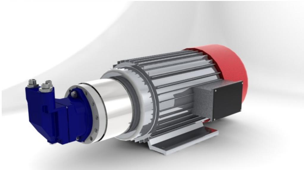
**DYNAGEN** Generatoren können von einer bereits vorhanden Load Sensing Hydraulikpumpe angetrieben oder als komplettes System geliefert werden. Die Frequenz wird vom Ölstrom geregelt. Durch die grosse Anzahl Zubehörteile lässt sich der Generator an Kundenspezifische Anforderungen anpassen.
